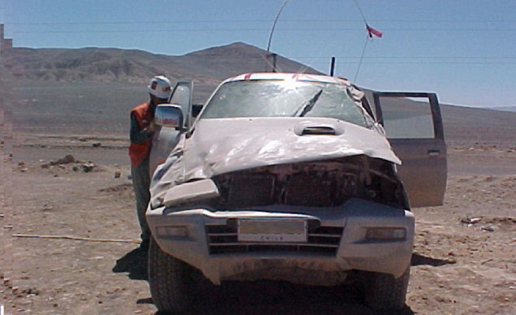
**ESTA IMAGEN MUESTRA UNA CAMIONETA CON BARRA INTERNA, Y QUE A PESAR DE SU VOLCAMIENTO NO SUFRIO MAYOR DAÑO EN SU CABINA DELANTERA NI TRASERA.**
